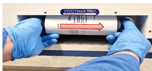
Slika 12.2 Postopek vstavljanja in odstranjevanja filtra VOC/HEPA
