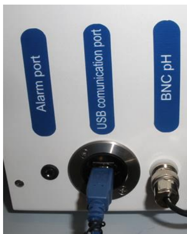
Slika 20.1 Priključevanje sonde za pH na BNC
