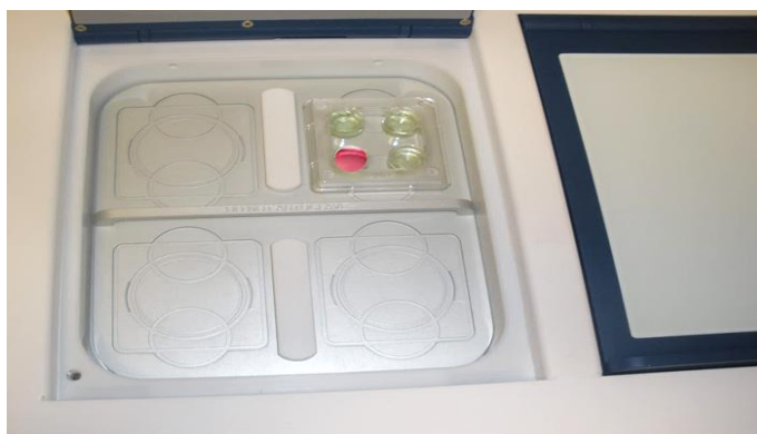
Slika 20.3 Petrijevka s štirimi jamicami s tremi pufri in gojiščem
